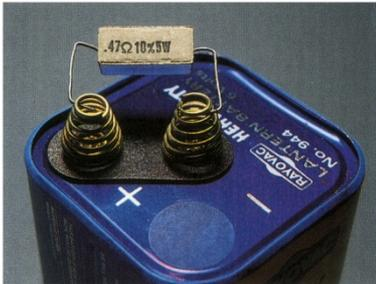
En una **batería real** la diferencia de potencial entre los bornes de la batería, denominada **tensión en los bornes** no es simplemente igual al valor de la fem de la batería.
